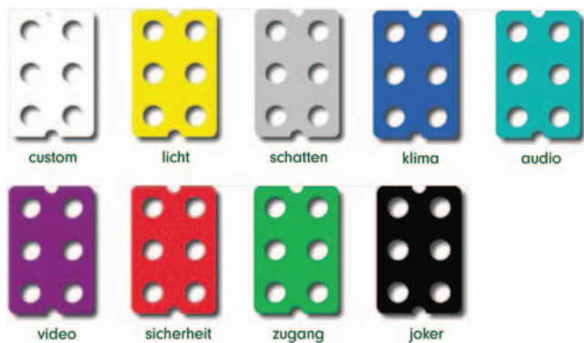
Bild 5 Farbcodes für die vorprogrammierten Digitalstrom-Klemmen
