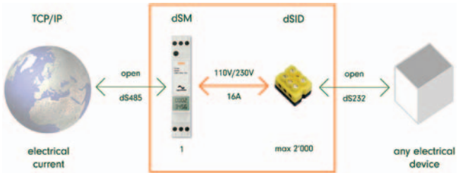
Bild 1 Grobschema von Digitalstrom: Für die Verschmelzung von Daten und Energie werden eine CPU, eine Messeinheit (Meter) und ein Modem benötigt
