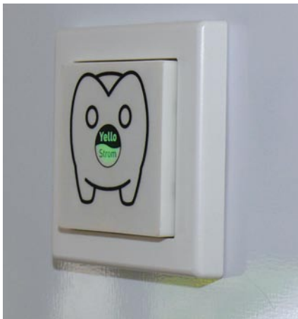
Bild 5 Anwendungsbeispiel in der Demonstrationswohnung von DigitalStrom in Wetzlar: Das Sparschwein leuchtet grün, wenn der Verbraucher wenig Energie braucht. Leuchtet es rot, weiss der Kunde, dass er gerade viel Energie bezieht.
