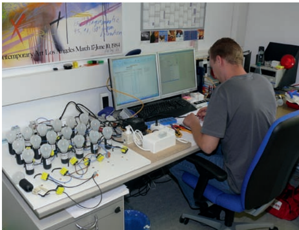
Bild 10 Im Labor werden seit zwei Jahren die digitalSTROM-Komponenten in Langzeittests auf Herz und Nieren geprüft.
