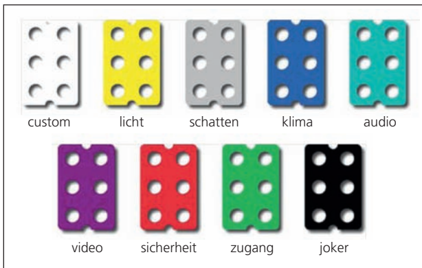
Bild 6 Einfach und übersichtlich: Die richtige Farbe für die entsprechende Anwendung, um Plug&Play zu ermöglichen.
